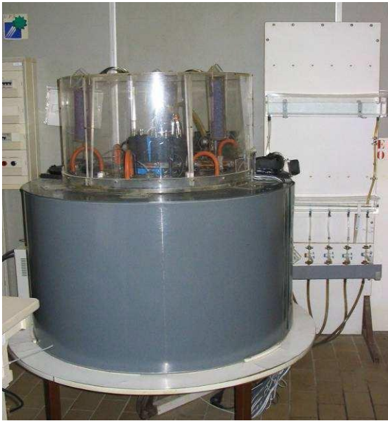
Figure 13.4 : Matériel pour l'essai de gonflement au gel 0/5 mm du Laboratoire Régional de l'Équipement de Nancy
