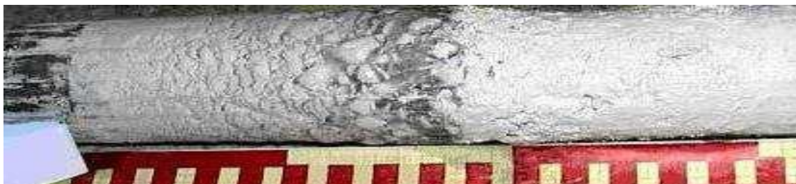
Figure 13.2 Gonflement d'un échantillon de craie sous l'effet du gel
